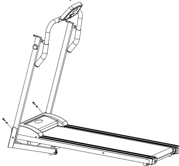
Закрепите их с помощью болта и шайбы с обеих сторон.
