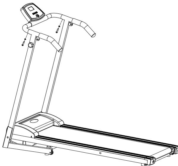
Закрепите с помощью болта и шайбы с обеих сторон (Не перетяните болты).
