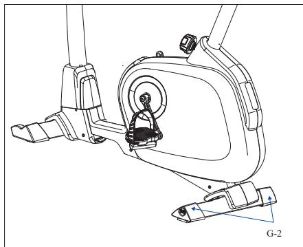
Используйте компенсаторы неровности пола (G-2), чтобы стабилизировать тренажер на неровной поверхности пола. Они расположены в нижней части задних стабилизаторов (справа и слева). Регуляторы нужно вращать вправо или влево пока тренажер не займет стабильное положение на полу.
