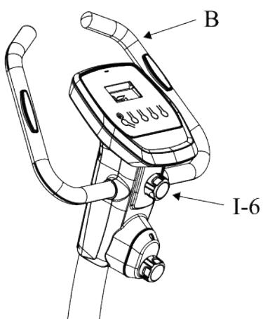
Сидя на тренажере, ослабьте фиксатор (I-6), чтобы разблокировать поручни. Установите поручни (B) в наиболее удобное положение. Затяните фиксатор (I-6), чтобы зафиксировать поручни в выбранном положении.
