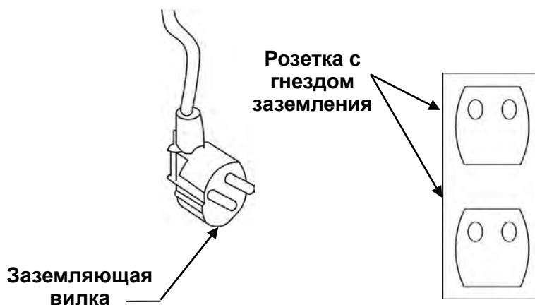
Рисунок 1. Подключение устройства к электросети
